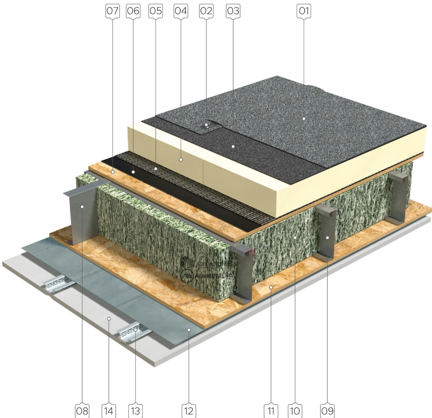
01 membrana bituminoasa armata si cu strat de protectie
